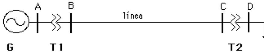
En el sistema de la figura, trabajando en pu base 100 MVA, se solicita calcular en por unidad
